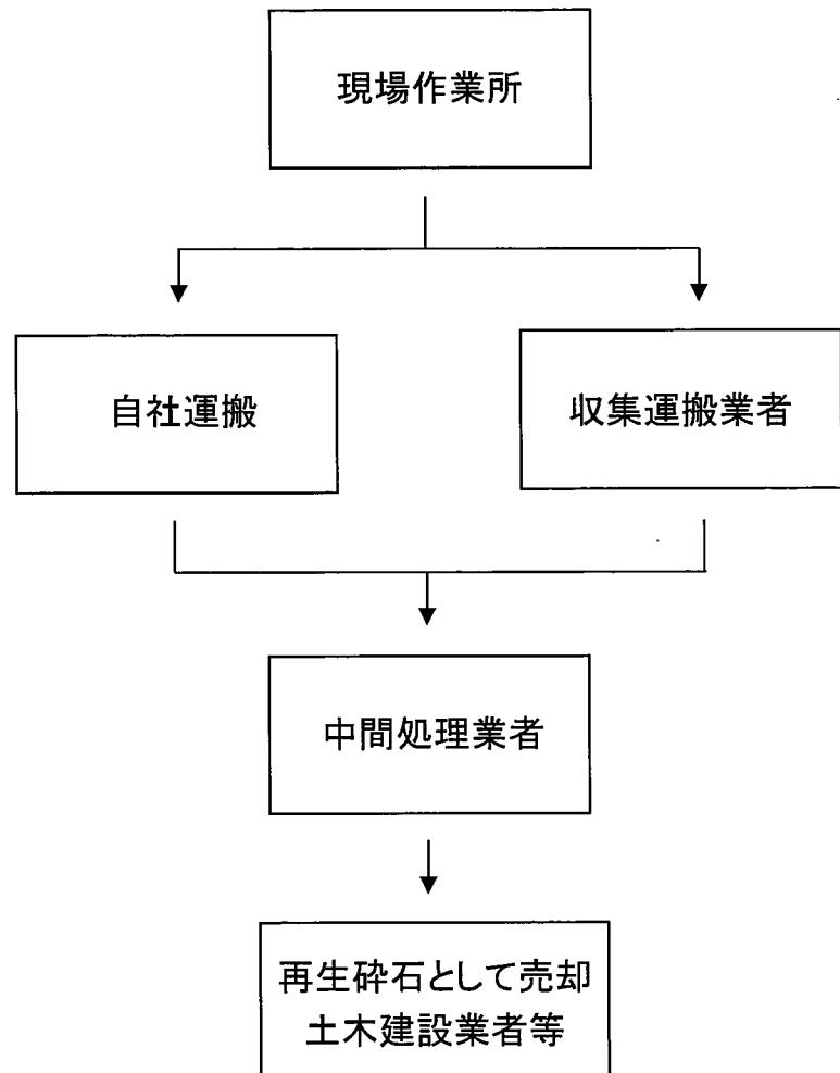
1. 各作業所より、解体等に伴い発生したコンクリート殻・アスファルト殻は現場責任者が管理し、マニフェストと共に収集運搬業・処分業者へ引き渡す。
