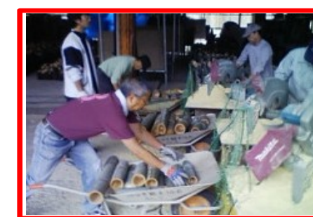
加工された竹灯籠を一輪車に乗せて運搬する作業。切断された20本程度の竹を一輪車に積み込み近くの集積所まで運搬します。運搬が間に合わないほどの早さで次々と竹が切断され、加工されていきます。
