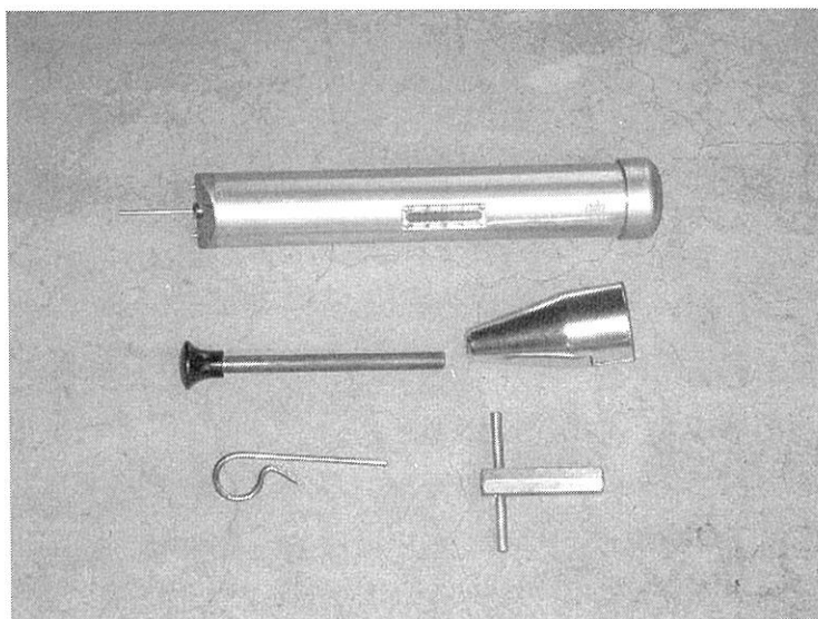
写真1 スイスPROCEQ社製のピロディン試験器 (Pilodyn 6J)
