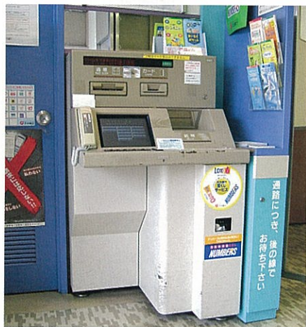
障害者が利用しやすいATM 車いす利用者や視覚障害者でも利用で きるよう、足元にスペースを確保する とともに、タッチパネルとは別に、点 字表示付きの操作盤を設置しています
