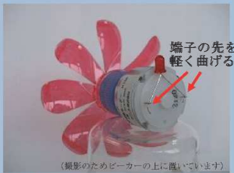
【図9】発光ダイオードを取り付ける
