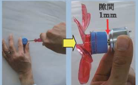
【図7】穴を開ける 【図8】軸を差し込む
