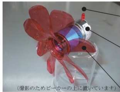
【図1】完成した風力発電機
