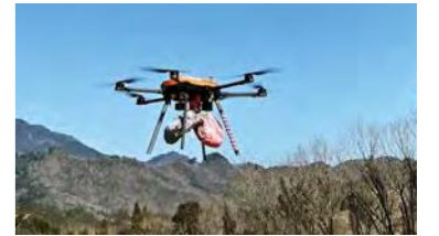
シカネットを運搬するドローン
