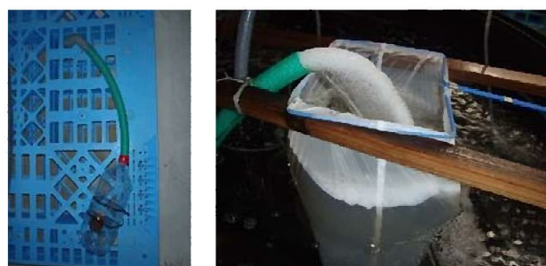
写真2 エアリフト式の揚水機(左)と揚水機稼働状況(右)
