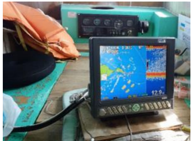
ガス湧出状況音波探査
