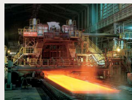
鋼を引きのばす工程
