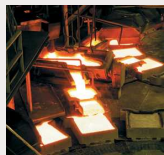
精製炉からアノードをつくる工程
