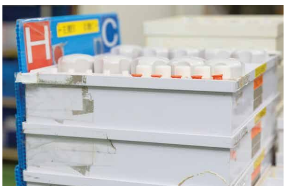
▲数えやすいよう、基盤の目ようになったキット箱。他にも、類似部品を覚えられない障がい者のために二次元バーコードを活用する等、様々な配慮を行っています。
