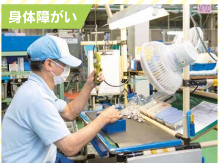
身体障がい 部品組立を担当。足に障がいがあるため、作業台の高さの調整、使用工具の吊り下げ方式の導入等、様々な工夫している。
