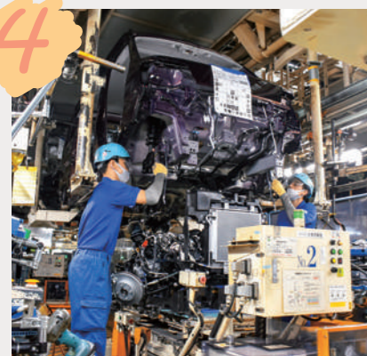
組立工程 塗装された車体に、エンジン、ステアリング、マフラー、タイヤ、ガラス、シートなどの部品が順序よく取り付けられ、自動車としてつくり上げられます。
