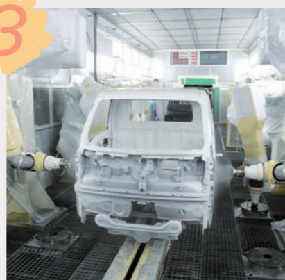
塗装工程 車体についた物などの汚れを落としてから、さび止め液の槽につけられます。その後、ロボットで塗装され、熱風を発生させるトンネルの中で焼きつけられます。
