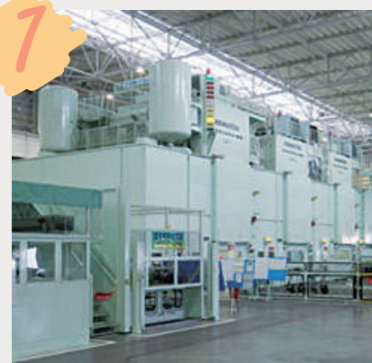
プレス工程 ロール状の鉄板を切断し、大型のプレス機で自動車のボデーを構成するドアやボンネットなどに成形します。
