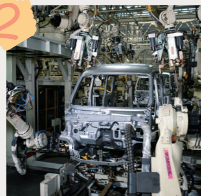
ボデー(溶接)工程 プレス工程で成形された部品を組み合わせ、ロボットで溶接し、車体をつくります。
