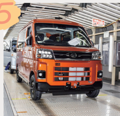
検査工程 出来上がった自動車は、ブレーキやハンドル、雨漏れ、傷など一台一台検査され、出荷ヤードに運ばれます。
