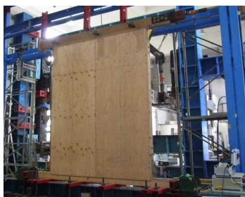
耐力壁の試験の様子（面内せん断試験）
