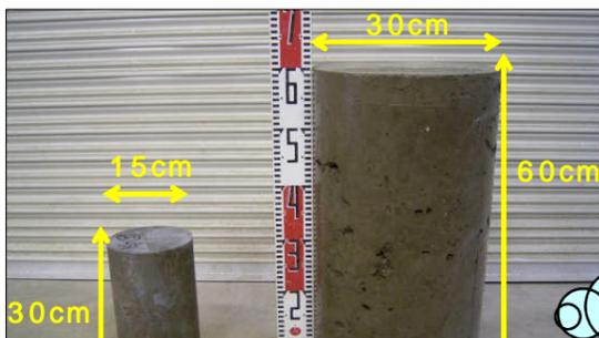
CSGは一般の生コンと比べて、大きな骨材(石)が入っています。そのため、供試体(テストピース)を作製するときは、写真のような大型供試体を作製して、圧縮強度試験などの試験を
