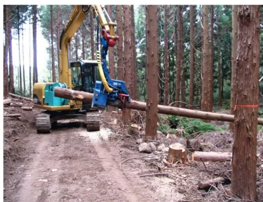
高性能林業機械による搬出間伐
