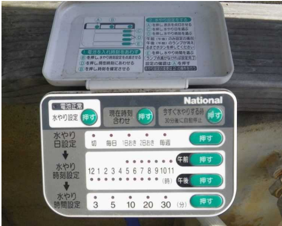
写真Ⅱ31-4 自動灌水装置（日、時刻、散水時間の設定が可能）
