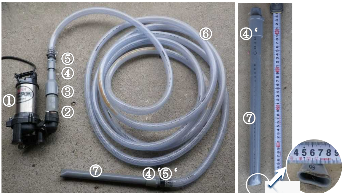
写真II32-1 センチピードグラスの吹付に使用した機材
