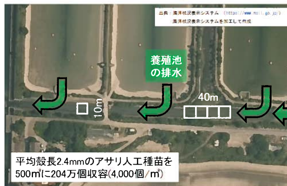
図1 クルマエビ養殖場排水路試験区の概要
