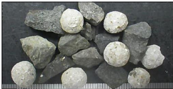
図1 ケアシェルと砕石の混合 (1目盛=1mm)
