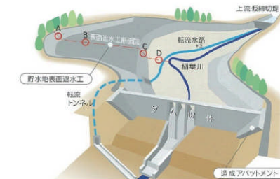
貯水池表面遮水工断面図位置
